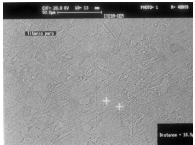
Figura 5. Microestructura de la muestra de titanio de alta pureza
