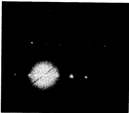
Fig. 5 Patrón de difracción electrónica de la fase dopada con Fe y concentración de x = 0.10 . Presenta una estructura tetragonal, con eje de zona [20\bar{1}] .
