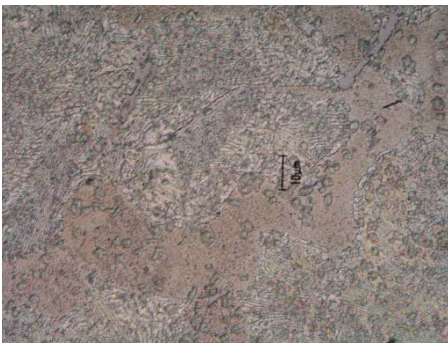
Figura 3: Micrografía de la muestra A 4, Zn - 22 % p Al, 60 horas de homogenización a 375 °C, no muestra estructura tipo perlita bien definida.
