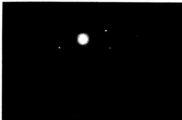
FIGURA 7.-Patrón de Difracción de Electrones a lo largo de [010] e identificado como SrMnO 3 .
