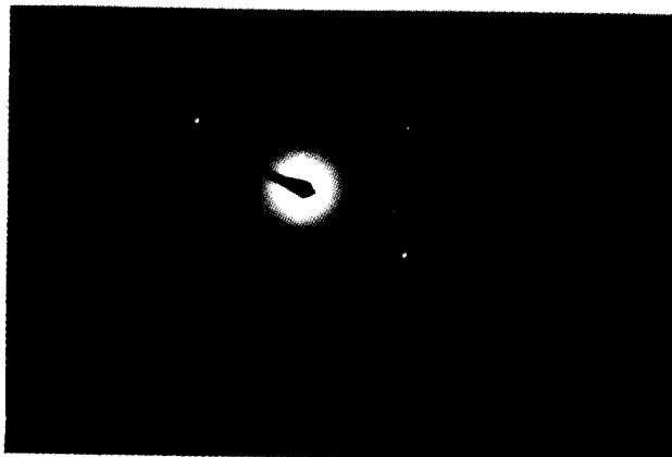
FIGURA 6.- Patrón de Difracción de Electrones a lo largo de [130] e identificado como SrMnO 3-x .
