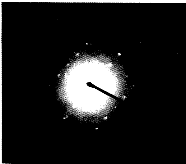
FIGURA 4.- Patrón de Difracción de Electrones a lo largo de [100] e indexado como La 4 Mn 4 O 11 .
