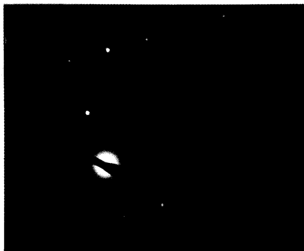
FIGURA 5.- Patrón de Difracción de Electrones a lo largo de [001] e identificado como SrMnO 2.694 .
