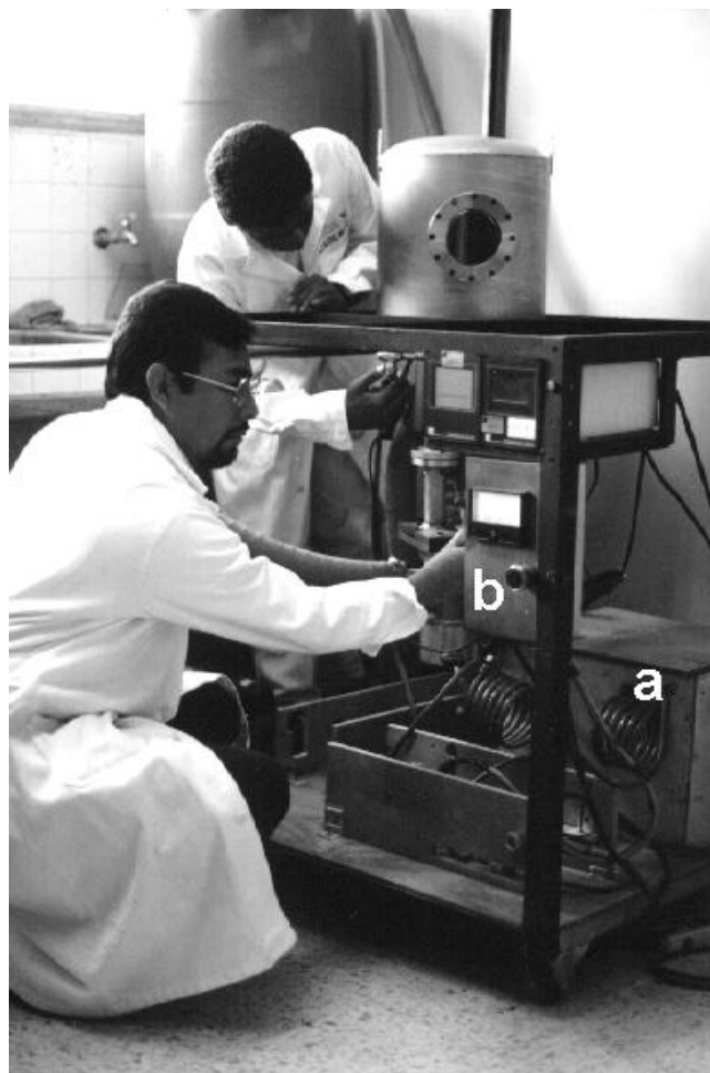
Figura 2. Evaporadora construida utilizando el sistema de alto vacío. Se aprecia en la imagen la fuente de alta corriente (a) con su control (b).
